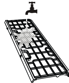
Fig.18 – Rinçage du filtre
